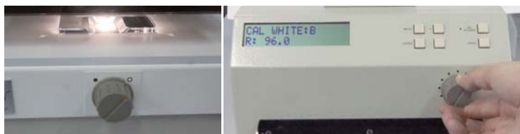
●シンプルなダイヤル操作でバックングやフィルターの切り替え
